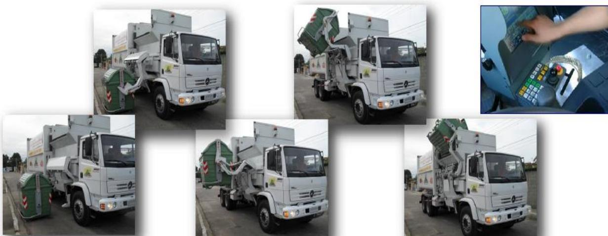
**Camión Recolector de carga lateral con caja desmontable.**
